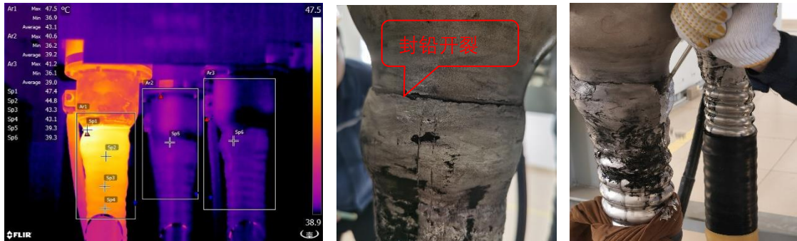
图 1 GIS 终端尾管发热（封铅密封）
