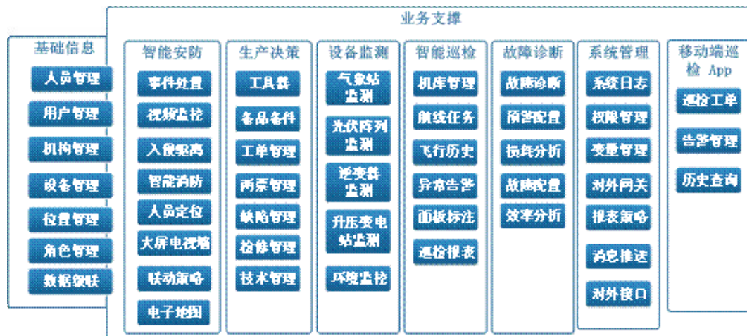
图 3 业务支撑系统功能模块图
