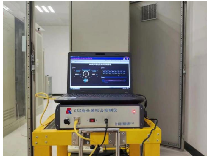
图 6 SSS 离合器啮合控制仪
