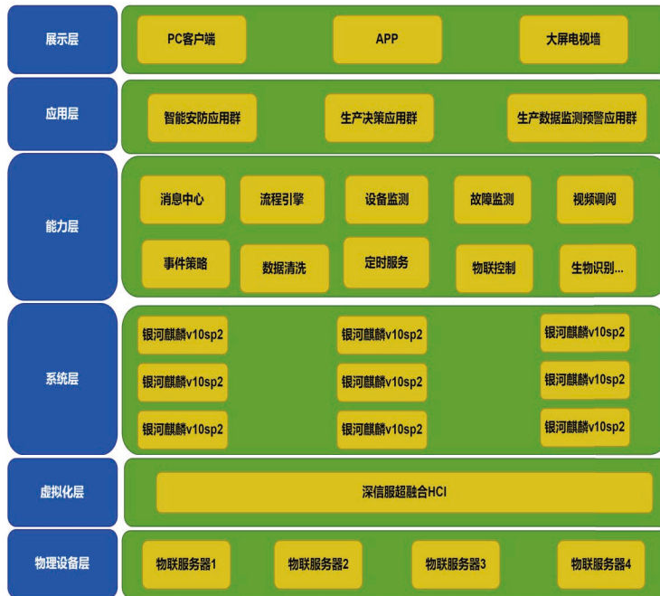
图 4 多层次系统架构图
