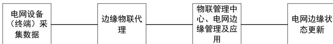
图 4-19 电网边缘设备运行状态维护过程
